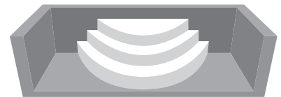
Römische Treppe (Innen)
