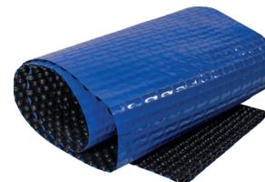
Eine Solarfolie heizt tagsüber das Schwimmbecken durch die eingeschweißten Luftkammern um bis zu 9° C auf. Die schwarze Unterseite und die GeoBubble Luftkammern verstärken den Wärmeeffekt zusätzlich. Nachts kann die Solarplane zudem durch die gute Isolation einen starken Wärmeverlust verhindern.
