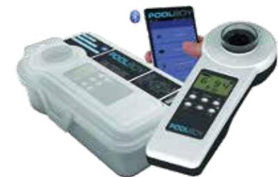
Einfach mit dem POOL BOY eine Wasserprobe entnehmen, den ZERO-Vorgang starten, eine Photometer-Tablette für die gewünschte Messung zugeben, zerstampfen, Lichtschutzkappe aufsetzen, die jeweilige Taste drücken und innerhalb weniger Sekunden wird Ihnen der gemessene Wert angezeigt. Mit den im Lieferumfang enthaltenen Testtablettchen lassen sich die für den Poolbetrieb gängigsten Werte messen: Chlor (frei/gebunden/gesamt), pH, Alkalinität sowie Cyanursäure.
